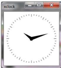
La fenêtre ci-contre doit apparaître. Si le message d'erreur **X connection to localhost:11.0 broken (explicit kill or server shutdown)** s'affiche dans le terminal, vérifier que le protocole X11 est activé (logo X en vert en haut à droite de la fenêtre). Si ce n'est pas le cas cliquer dessus, attendre quelques secondes son activation et relancer la commande xclock.
